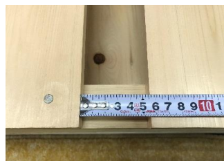
6 約5.6cm間隔で上板を止めていきます。 (オプションで上板を追加した場合は、約2.5cm間隔になります。)
