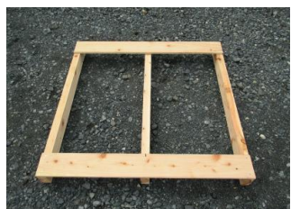
3 上板を2枚並べ、前と奥の上板の両端を釘で止めて下さい。
