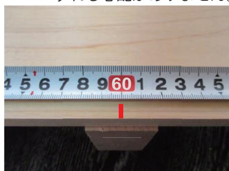
**6** 上板60cmに印を付け、桁の中心と合わせて下さい。
