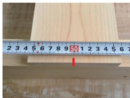
**4** 桁の50cmに印を付け、上板の中心と合わせて下さい。
